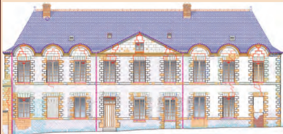
Façade Ouest, plan de réfection
